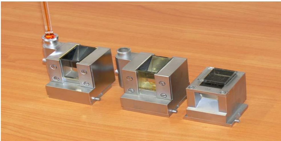
Rys.6 Pryzmaty stosowane w refraktrometrze PR-2 .
